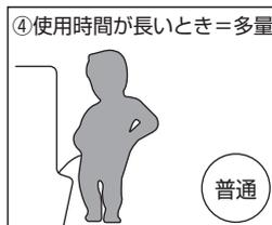
※連続して5回少なめの水量を流したときは必ず6回目に普通の水量を流します。
