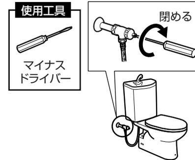
**マイナスドライバーで右に止まるまで回して、止水栓を閉める。**
