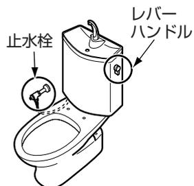
1. 止水栓を閉めてから(マイナスドライバーで右に止まるまで回す)、タンク内の水を流す。
