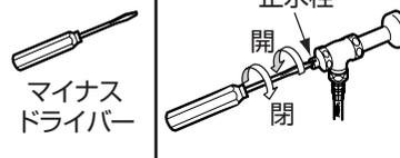
マイナスドライバーで矢印の方向に回して開閉する。
