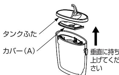
1. 止水栓を閉めてから(マイナスドライバーで右に止まるまで回す)、タンク内の水を流す。
