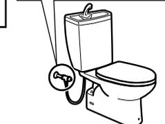
マイナスドライバーで右に止まるまで回して、止水栓を閉める。
