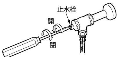
マイナスドライバーで矢印の方向に回して開閉する。
