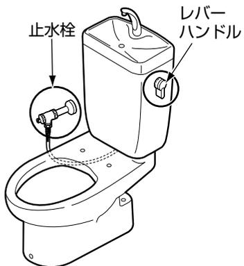
1. 止水栓を閉めてから(マイナスドライバーで右に止まるまで回す)、タンク内の水を流す。
