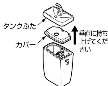
1. 止水栓を閉めてから(マイナスドライバーで右に止まるまで回す)、タンク内の水を流す。
