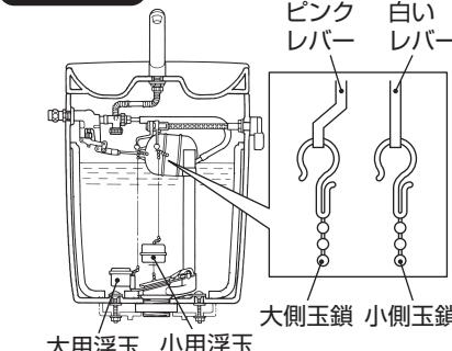
①大用浮玉（ピンク浮玉）につながっている玉鎖は、大用レバー（ピンクレバー）につないでください。
