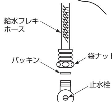
\*給水フレキホース内の水が少し流れ出ますので、バケツなどの容器で受けてください。
