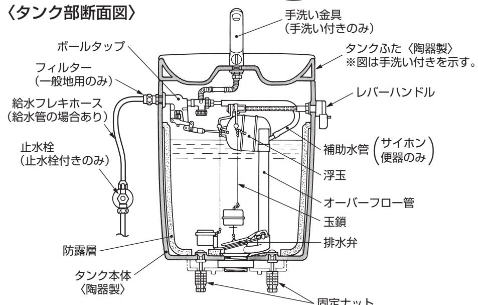
※防露タンクは、陶器製のタンク内の内側に樹脂製の防露層を貼り付けた構造になっています。
