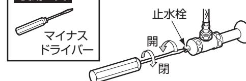
マイナスドライバーで矢印の方向に回して開閉する。
