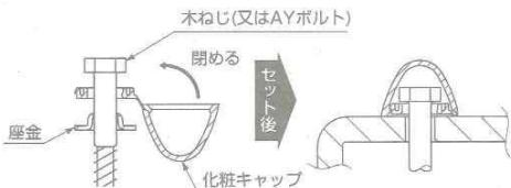
■ねじを取付けた後は、化粧キャップを矢印の方向に曲げて、「パチッ」と音がするまで押し込んでください。
