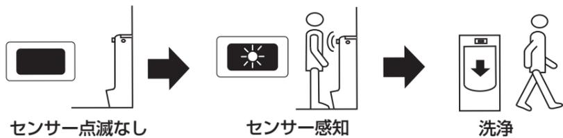
※人体感知のない状態で光電センサーが点灯しているときは、光電センサーが感知距離の自動調整を行っています。ランプの点灯が消えるまでお待ちください。(詳細は「⑩光電センサー感知距離調整」をご確認ください)
