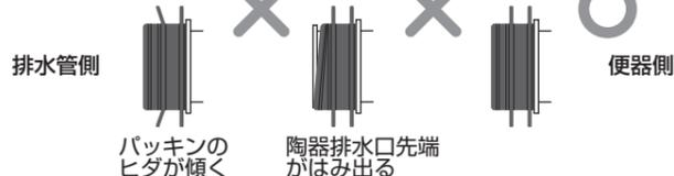
便器排水口高さ、口径の陶器公差・排水管の高さの施工誤差によっては、パッキンがはみ出すことがあります。水溜試験の結果、水漏れしていなければパッキンがはみ出しても品質的に問題はございません。
