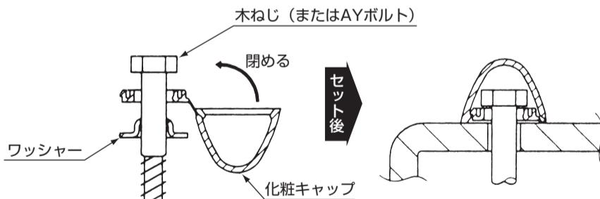
■ねじを取り付けたあとは、化粧キャップを矢印の方向に曲げて、「パチッ」と音がするまで押し込む。
