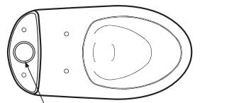
下図のようにロータンクを真っすぐ下ろすように便器に取り付けると確実にシールできます。
