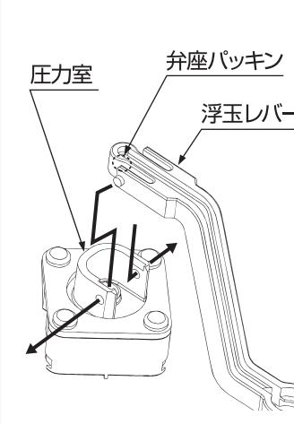
浮玉レバーに弁座パッキンがついていることを確認し、浮玉レバー先端の突起部(2力所)を圧力室の穴(2力所)へ、確実にはめ込んでください。
