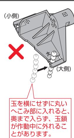
排水弁が上がらない程度に玉鎖を張った状態でスリットに差し込む。
