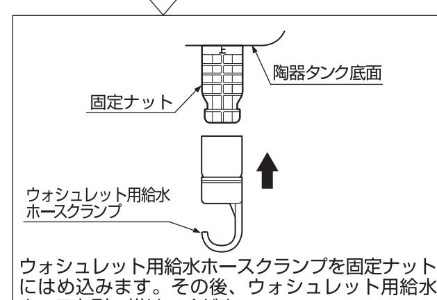
ウォシュレット用給水ホースクランプを固定ナットにはめ込みます。その後、ウォシュレット用給水ホースを引っ掛けてください。
