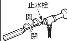
マイナスドライバーで矢印の方向に回して開閉する。
