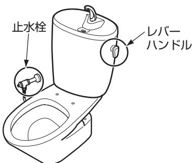
1. 止水栓を閉めてから(マイナスドライバーで右に止まるまで回す)、タンク内の水を流す。
