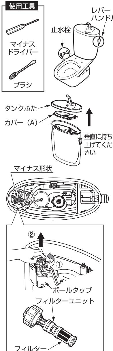
1. 止水栓を閉めてから(マイナスドライバーで右に止まるまで回す)、タンク内の水を流す。流したあと、タンク内に給水されていないことを確認する。
