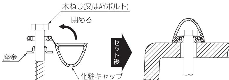
■ねじを取付けた後は、化粧キャップを矢印の方向に曲げて、「パチッ」と音がするまで押し込んでください。
