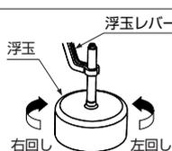
止水位がウォーターライン(標準水位)に合っていない場合のみ下図の要領で調整してください。
