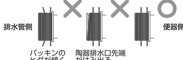
便器排水口高さ・口径の陶器公差・排水管の高さの施工誤差によっては、パッキンがはみ出ることがあります。
