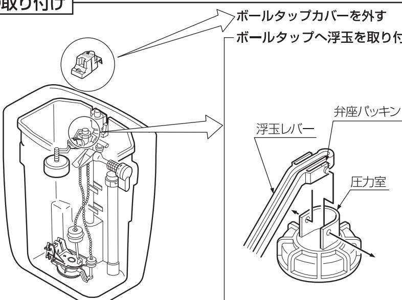
浮玉レバーに弁座パッキンがついていることを確認し、浮玉レバー先端の突起部(2力所)を圧力室の穴(2力所)へ、確実にはめ込んでください。
