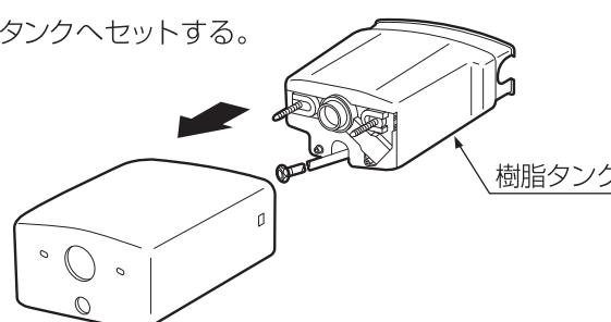
③ 止め輪で取付ボルトを固定する。
