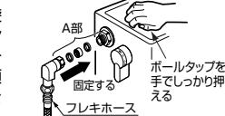
③ フレキホースの袋ナット部にパッキンおよびフィルターを右図のように順番に挿入し、A部を固定する。
