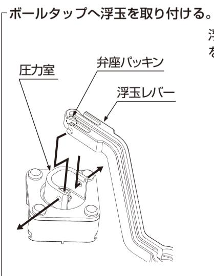
浮玉レバーに弁座パッキンがついていることを確認し、浮玉レバー先端の突起部(2力所)を圧力室の穴(2力所)へ、確実にはめ込んでください。
