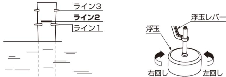
WL表示ラインは、オーバーフロー管の3カ所に止水位をセットできる構造になっていますが、水量にあわせて所定の位置にセットして出荷しています。
