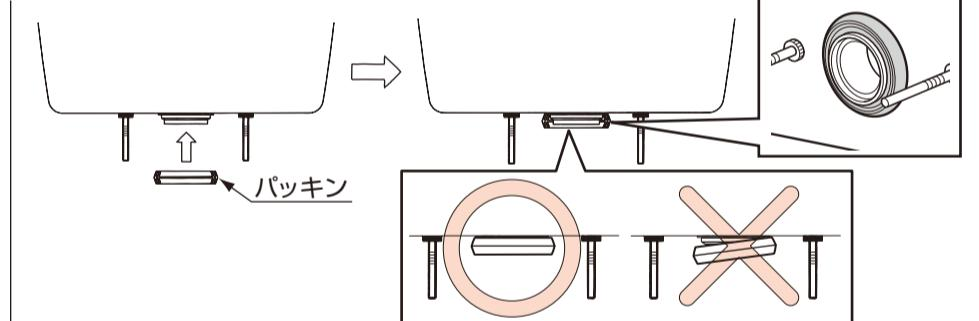
③固定ナットでロータンクを固定する。
