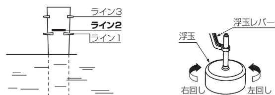
WL表示ラインは、オーバーフロー管の3カ所に止水位をセットできる構造になっていますが、水量に合わせて所定の位置にセットして出荷しています。
