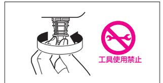
**注意** ワンタッチナットを締め付けるときは必ず手で行う工具を使用すると破損するおそれがあります。
