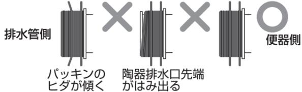
排水ソケットの高さ、排水ソケット口径の陶器公差・排水管の高さの施工誤差によっては、パッキンがはみ出すことがあります。水溜試験の結果、水漏れしていなければパッキンがはみ出しているても品質的に問題はありません。
