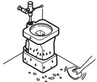
汚物流しと床、汚物流しと補高台、補高台と床のすき間には、防カビ性のシリコン系シーラントを必ず塗布する
