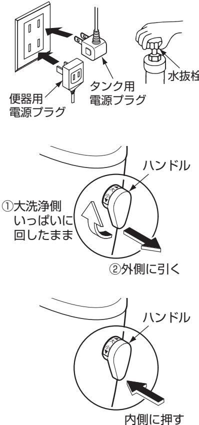
1. タンクおよび便器用電源プラグをコンセントに差し込む。
