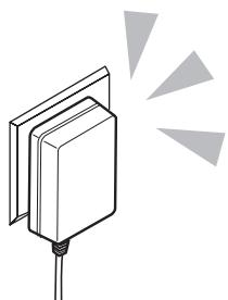
ACアダプターの差し込みプラグを根元まで確実にコンセントに差し込む
