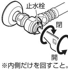
開閉工具またはマイナスドライバーで矢印の方向に回して開閉する。
