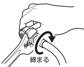
※給水フレキホース内の水が少し流れ出ますので、バケツなどの容器で受けてください。
