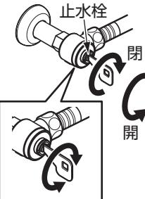
**開閉工具またはマイナスドライバーで矢印の方向に回して開閉する。**
