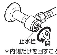
2. 袋ナットを締め増ししても水漏れが止まらない場合は、パッキンを交換する。
