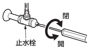
マイナスドライバーで矢印の方向に回して開閉する。
