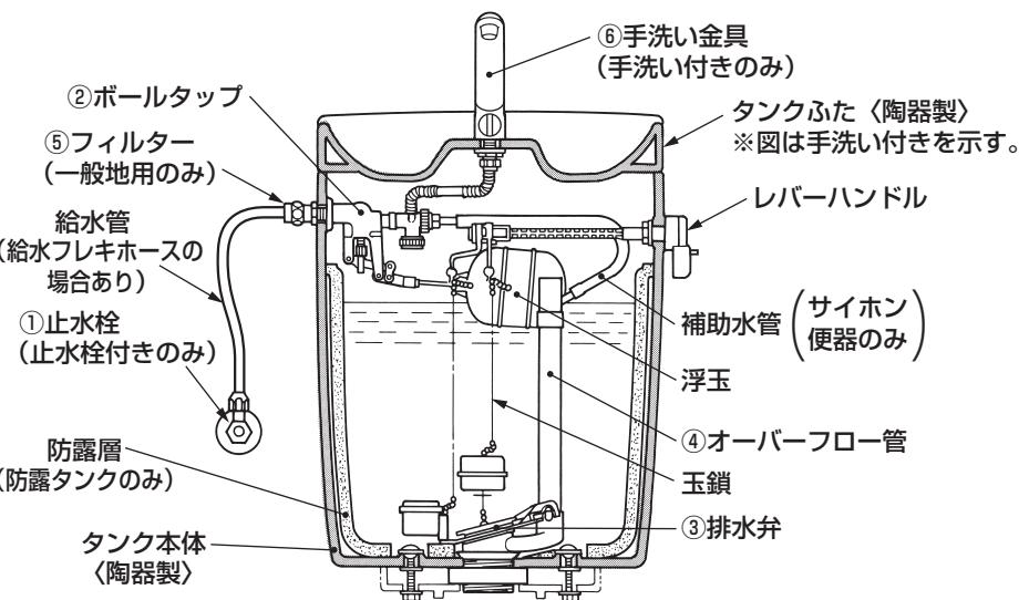
※防露タンクは、陶器製のタンク内の内側に樹脂製の防露層を張り付けた構造になっています。
