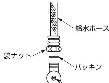
※給水ホース内の水が少し流れ出ますので、バケツなどの容器で受けしてください。
