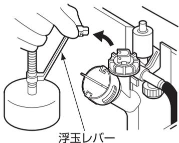
1. 止水栓を閉めてから (マイナスドライバーで右に止まるまで回す)、タンク内の水を流す。流したあと、タンク内に給水されていないことを確認する。
