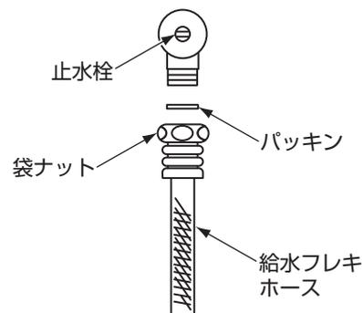
※給水フレキホース内の水が少し流れ出ますので、バケツなどの容器で受けてください。
