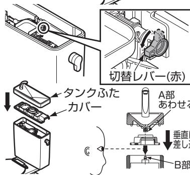
※上記の方法により、低い水たまり面に水が補給され(約500ml程度)、正常な状態に戻るようになります。
