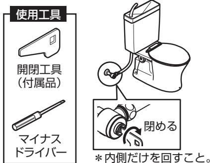
開閉工具またはマイナスドライバーで右に止まるまで回して、止水栓を閉める。
