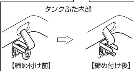
2. 六角穴付きボルトを締め付け、タンクふたに固定する。
