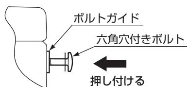
2. 六角穴付きボルトをボルトガイドに押し付け、タンクふたを垂直に持ち上げ、外す。
