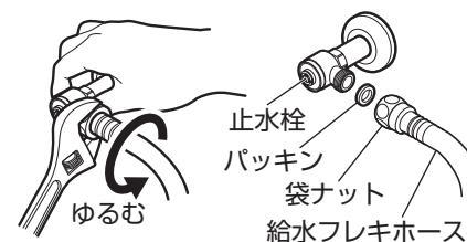
\*給水フレキホース内の水が少し流れ出ますので、バケツなどの容器で受けてください。
