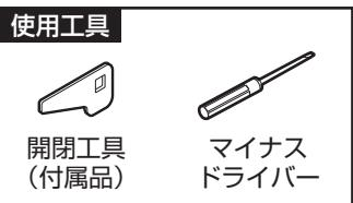
開閉工具またはマイナスドライバーで右に止まるまで回して、止水栓を閉める。
