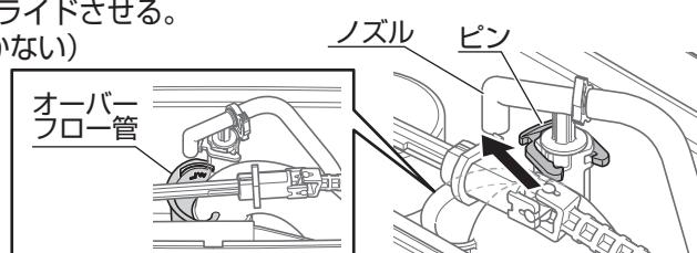
(2) オーバーフロー管側にノズルを回転させる。
