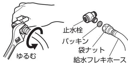
※給水フレキホース内の水が少し流れ出ますので、バケツなどの容器で受けてください。
