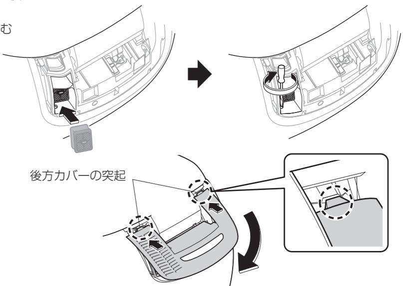
6 本体の後方カバーを取り付け、電源プラグを差し込む
