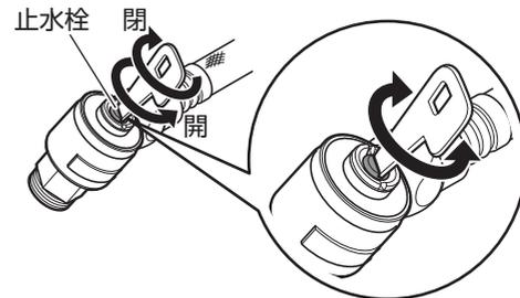
開閉工具またはマイナスドライバーで矢印の方向に回して開閉する。
