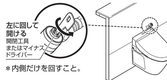
② ボールタップを回し、止水位を確実にあわせる。
