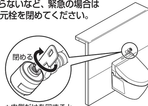
開閉工具またはマイナスドライバーで右に止まるまで回して、止水栓を閉める。
