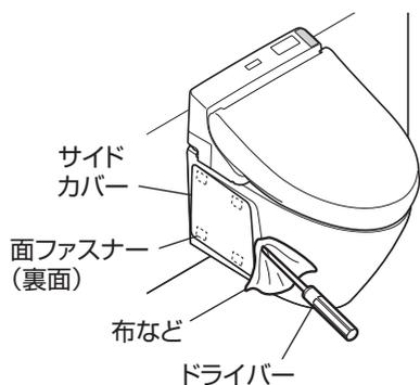
サイドカバー手前側と便器のすき間に、ドライバーのような先の細い治具を差し込み、カバーを浮かしながら取り外す。
