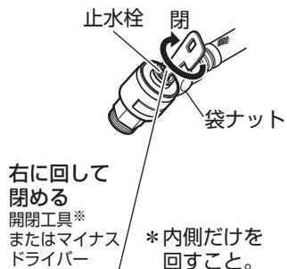
② モンキーレンチで袋ナットを『締まる』の方向に回して締め増しします。
