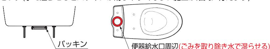
下図のようにロータンクを真っすぐ下ろすように便器に取り付けると確実にシールできます。
