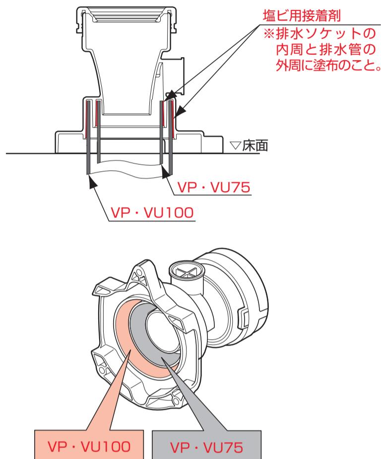
※排水管の切断面のバリ、汚れは必ず除去してください。
