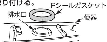
※Pシールガスケットを先に排水フランジ側に取り付けると、排水管内へはみ出し、機能を阻害するおそれがあります。
