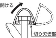
②木ねじを取り付けたあとは、化粧キャップを矢印の方向に曲げて、「パチッ」と音がするまで押し込む。
