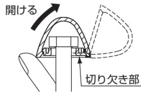
② 木ねじを取り付けたあとは、化粧キャップを矢印の方向に曲げて、「パチッ」と音がするまで押し込む。
