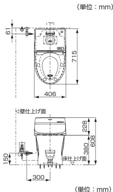
商品セット図 (施工完了図) 床給水タイプ
