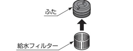
⑤ 給水フィルターを元の位置に取り付け、ふたを開閉工具で締め付ける。
