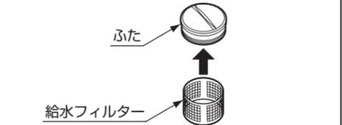
⑤ 給水フィルターを元の位置に取り付け、ふたを開閉工具で締め付ける。
