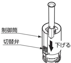
⑤ 制御筒を時計回りに回し取り付ける。
