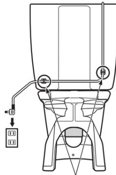
コードクランプ2個をコード取出口下方と反対側下方に貼り付けます。
