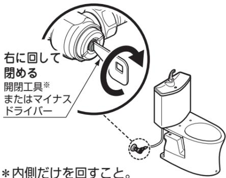
※付属の開閉工具をご使用ください。作業が完了したら、必ずお客様にお渡ししてください。
