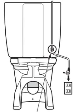
コードクランプ1個をコード取出口下方に貼り付けます。
