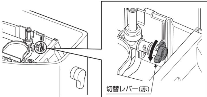
④ フックを解除し、ボールタップのタンク取付位置を下段に変更する。
