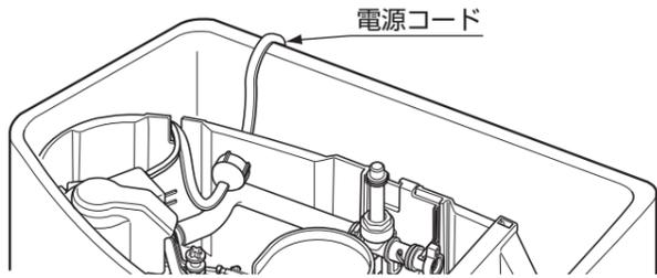
②コードクランプ裏面の剥離紙をはがし、両面テープ面をタンク裏面にしっかりと押さえ付けて貼る。
