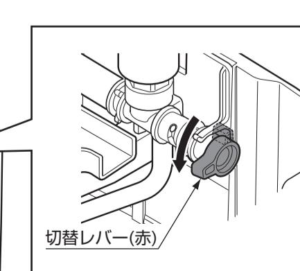
④ボールタップの浮玉取付位置を、下段の凹部に変更する。
