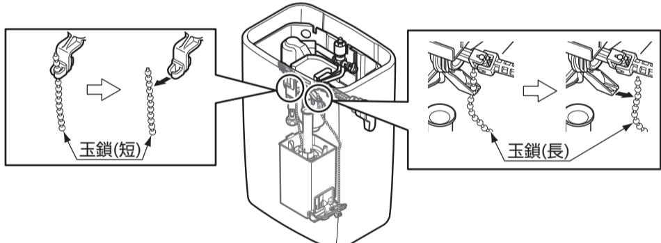
②制御筒を反時計回りに回し外す。
