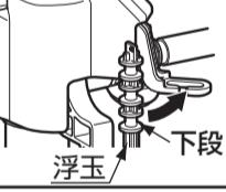
⑤フックを解除し、ボールタップのタンク取付位置を上段に変更する。
