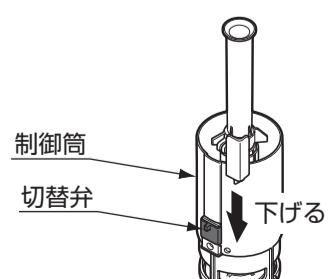
④制御筒を時計回りに回し取り付ける。
