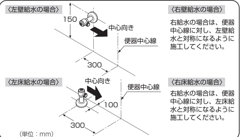
\*止水栓は必ず製品同梱の専用止水栓(フィルター付き)を取り付けてください。
