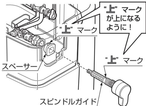
③スピンドルガイドにナットをねじ込み、ナットを握って力強く手締めしたあと、工具で90°以上増し締めする。
