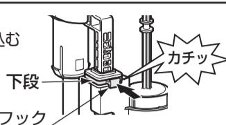
⑤ボールタップの浮玉取付位置を、上段の凹部に変更する。
