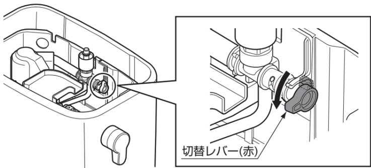
④ フックを解除し、ボールタップのタンク取付位置を下段に変更する。
