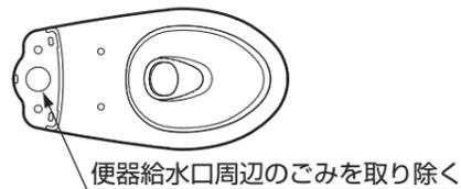
下図のようにロータンクを真っすぐ下ろすように便器に取り付けると確実にシールできます。
