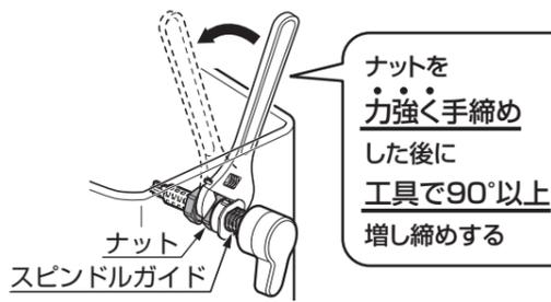
ナットを力強く手締めした後に工具で90°以上増し締めする
