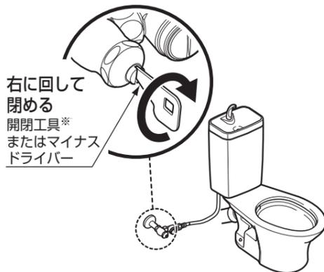
※付属の開閉工具をご使用ください。作業が完了したら、必ずお客様にお渡ししてください。
