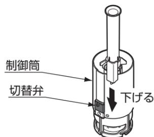
④ 制御筒を時計回りに回し取り付ける。
