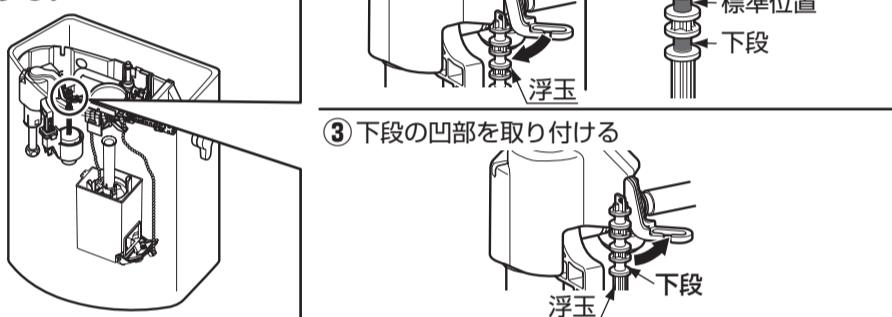
⑤フックを解除し、ボールタップのタンク取付位置を上段に変更する。
