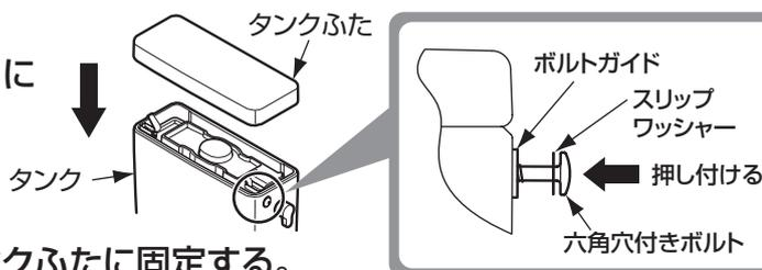
②六角穴付きボルトを締め付け、タンクふたに固定する。
