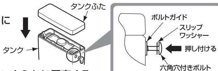
②六角穴付きボルトを締め付け、タンクふたに固定する。
