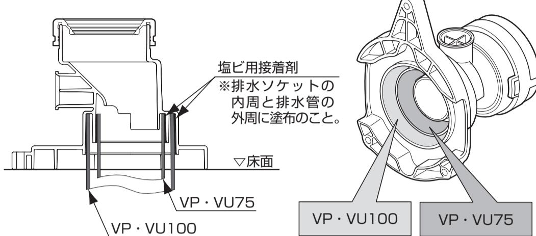
※排水管の切断面のバリ、汚れは必ず除去してください。
