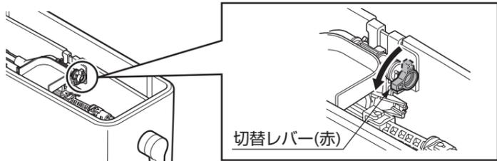
④ ボールタップの浮玉取付位置を、下段の凹部に変更する。
