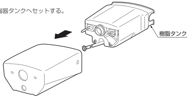
③ 止め輪で取付ボルトを固定する。
