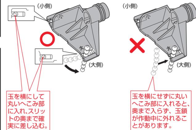
排水弁が上がらない程度に玉鎖を張った状態でスリットに差し込む。
