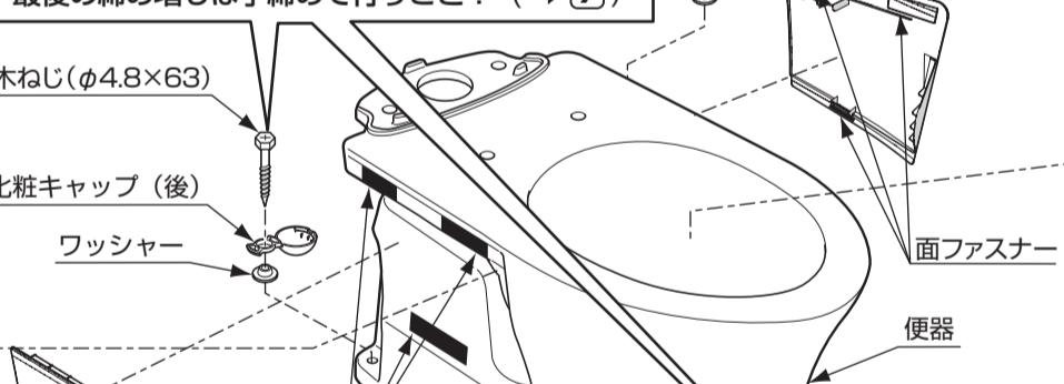
※ヒーター付便器、水抜き方式の場合は、給水ホースの水抜き勾配を確保できるように取り付けてください。取付方法は、ウォシュレット本体同梱の施工説明書を参照してください。
