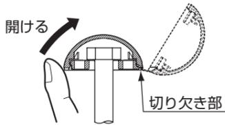
② 木ねじを取り付けたあとは、化粧キャップを矢印の方向に曲げて、「パチッ」と音がするまで押し込む。
