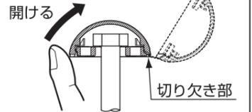
② 木ねじを取り付けたあと、化粧キャップを矢印の方向に「パチッ」と音がするまで押し込む。
