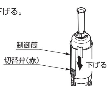
⑤制御筒を時計回りに回し取り付ける。
