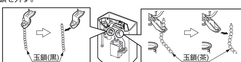
③制御筒を反時計回りに回し外す。
