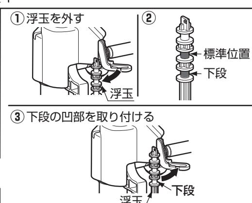
⑤フックを解除し、ボールタップのタンク取付位置を上段に変更する。
