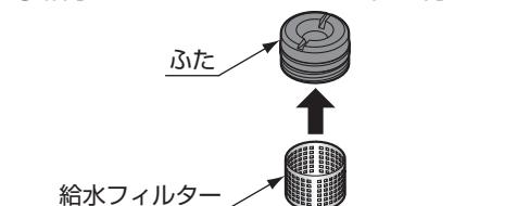
⑤給水フィルターを元の位置に取り付け、ふたを開閉工具で締め付ける。
