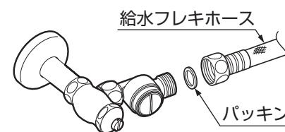
※給水フレキホースが折れないように接続方向を調整してください。
