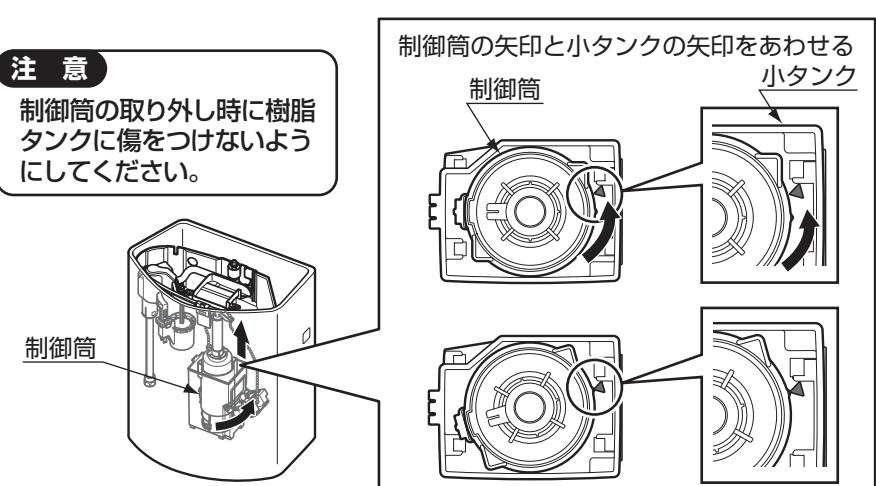
④制御筒横の切替弁(赤)を下げる。
