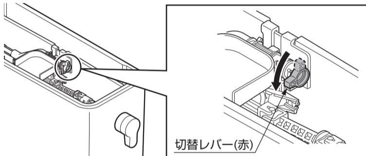
④フックを解除し、ボールタップのタンク取付位置を下段に変更する。
