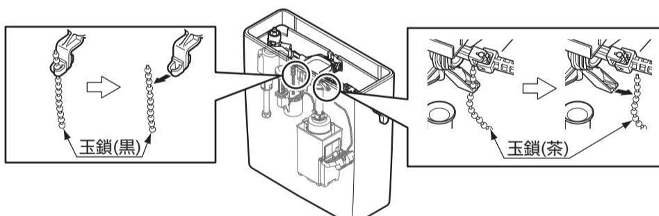
②制御筒を反時計回りに回し外す。
