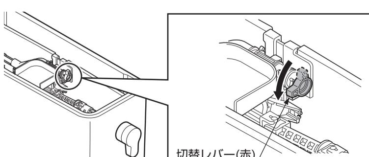
④ボールタップの浮玉取付位置を、下段の凹部に変更する。
