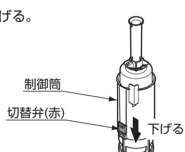
④制御筒を時計回りに回し取り付ける。
