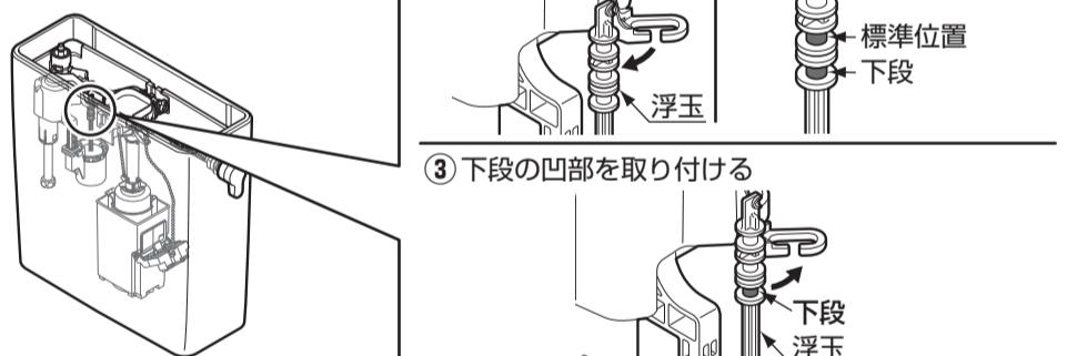
⑤フックを解除し、ボールタップのタンク取付位置を上段に変更する。
