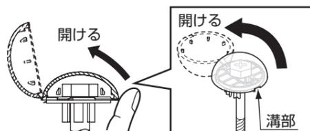
② 化粧キャップを矢印の方向に曲げて、「パチッ」と音がするまで押し込む。
