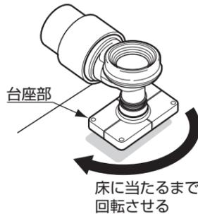
④台座が壁に平行になるように調整し、排水ソケット中心線をけがく。
