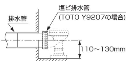
②台座を縮めた状態で、排水管に排水ソケットを差し込む。
